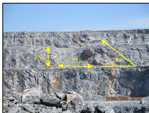
ภาพที่ 1.7 การออกแบบหน้าเหมืองทำเป็นลักษณะขั้นบันได
